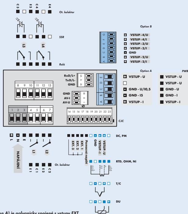
\*GND (Option A) je galvanicky spojený s vstupy EXT. a konektorem OM Link
