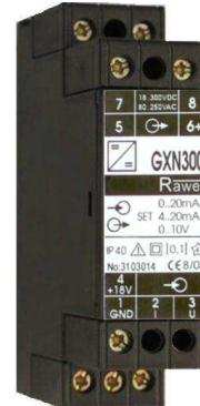
Modul slouží ke galvanickému oddělení s možností vzájemného převodu standardních proudových nebo napěťových signálů 0-20mA, 4-20mA a 0-10V. Z převodníku je vyveden na vstupní straně nestabilizovaný zdroj napětí 18V/20mA. Typické je použití modulu jako galvanicky odděleného zdroje pro napájení dvouvodičového převodníku napájeného po signálu 4-20mA. Na výstupu z převodníku je aktivní signál galvanicky oddělený od vstupu i od pomocného napájecího zdroje.
