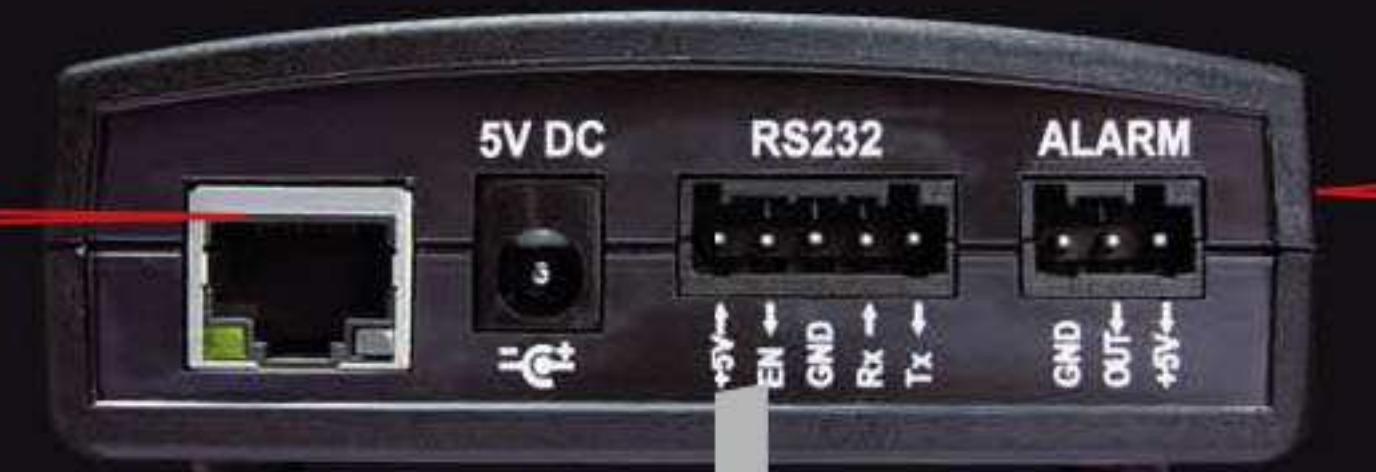
Pro komunikaci s PC a dalšími systémy je přístroj vybaven rozhraním USB (umístěn na boční straně přístroje), RS232 a Ethernet.
